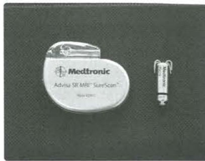
写真1 左から従来型のペースメーカー、カプセル型のリードレスペースメーカー
